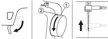
10. Abbassare la leva alza piedino. Portare l'ago in alto ruotando il volantino verso sè; la freccia disegnata sul volantino deve combaciare con la linea posta sulla scocca laterale.
