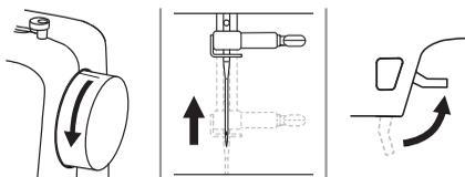
8. Terminata la cucitura, rilasciare il pedale di comando (reostato), ruotare il volantino verso sè e rimuovere la stoffa da sotto al piedino.
